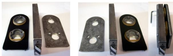
Die beiden losen Platten müssen nun getauscht werden. Danach können die Schlossplatten wieder zusammen mit dem Schloss montiert werden
