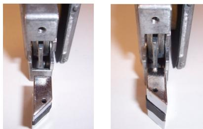
Ziehen Sie die Falle aus dem Schloss heraus drehen diese um 90° und setzen die Falle wieder in das Schloss ein und ziehen die Senkschrauben wieder fest an.
