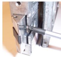
Nun muss die Falle noch gedreht werden. Öffnen Sie dazu zunächst mittels eines Kreuzschraubendrehers die Senkkopfschraube in der Falle.
