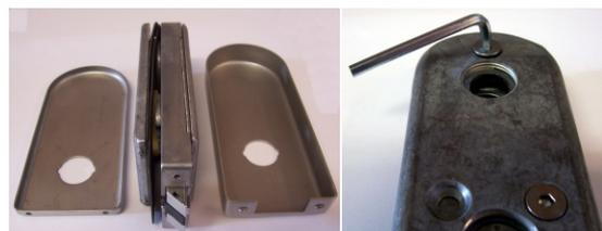
Wenn die die Schlosskappen entfernt haben können Sie das Schloss mit dem beiliegenden Innensechskant - Schlüssel demontieren.
